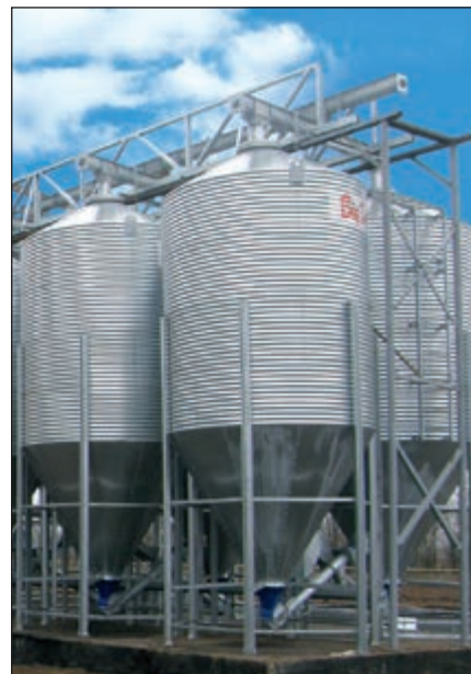
Udendørs siloer til opbevaring af grundkomponenterne
