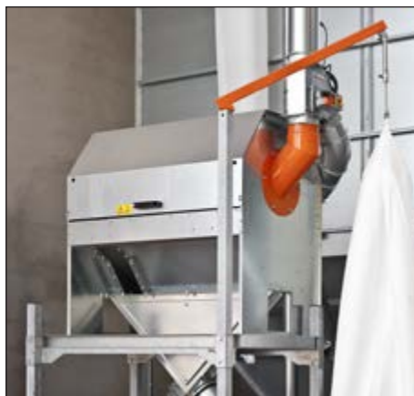
Tromlerenser T1 monteret i mølleri
